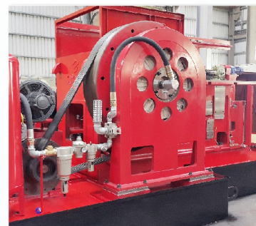
離合器可蓄能便於吋動並可依產品無段變速調整 (標準)
